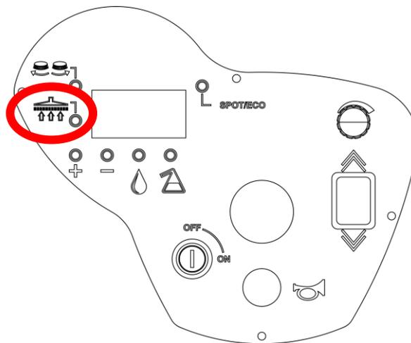
En appuyant longuement sur la touche de la fonction d'aspiration (> 3 secondes), la fonction d'aspiration s'enclenche même lorsque la machine est à l'arrêt, le siège du conducteur ne doit pas être occupé. Une fois le travail terminé, désactivez la fonction d'aspiration en appuyant brièvement sur la touche.
