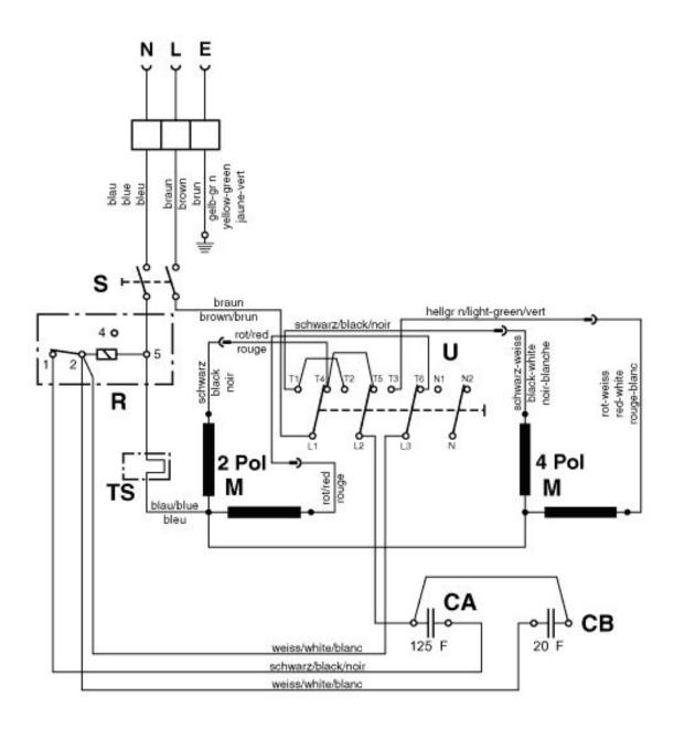
S = Schalter B rstmotor / Tumbler switch for motor / Interrupteur pour moteur
